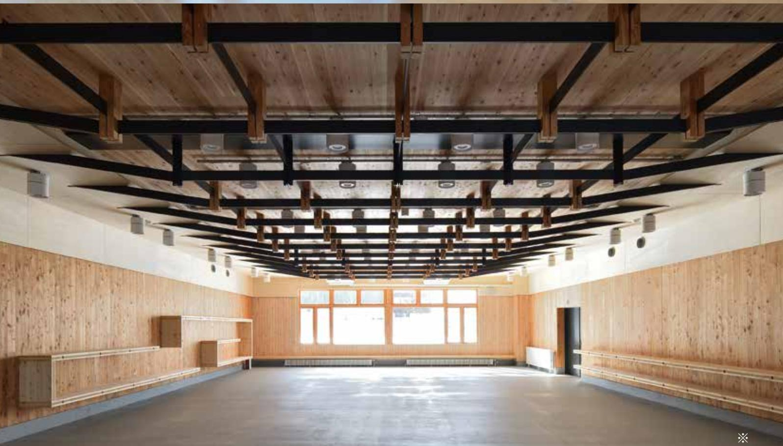
**実習室：** エントランスからホールを介し視認性の良い配置の実習室は、10.8m×18.5mの木造としては大きなスケールを無柱空間として計画した。Y方向のカラマツCLT壁で、上部のCLT床パネルを受ける構成である。床パネルのCLT床版は概ね1.2m×6mのパネルを敷並べ、そのパネルをX、Yの双方向からスチールバーでプレストレスを導入して剛性を高めることで、大スパンの架構を可能にしている。無柱空間の実習室は実習活動の幅を広げ、多様な授業展開が可能になる
