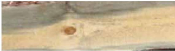
図6 アカマツ丸太の製材時に見られた辺材部の青変
