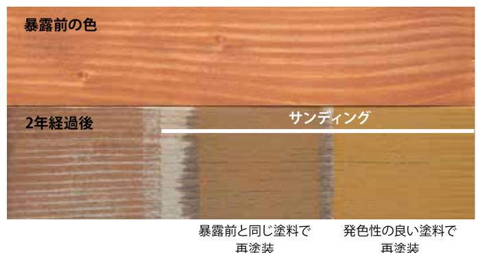
図8 サンディング後の再塗装と塗料による発色性の差異
