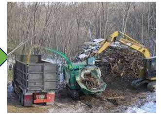
【土場】 山土場に搬入したチップパー機で生産したチップをダンプへ直接積込
