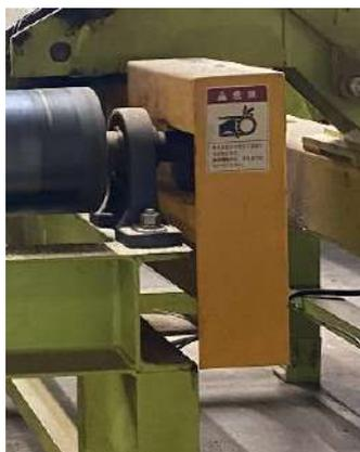
駆動部カバーの確実な取り付け
